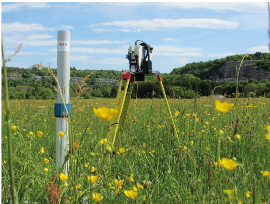
Dispositif de spectrométrie gamma et de mesure du débit d'équivalent de dose (Constat radiologique « Zones de rémanence élevée »).
